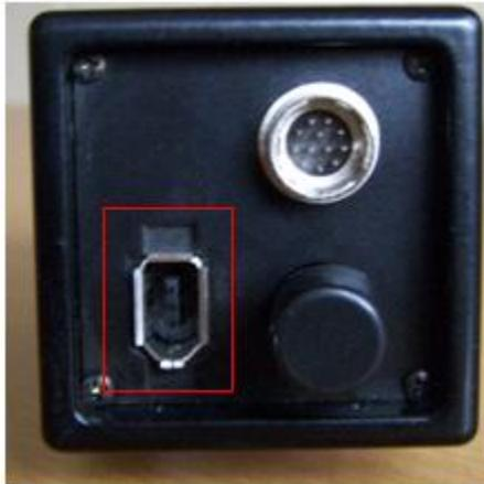
**Figura 5** – Interface Firewire da câmara
