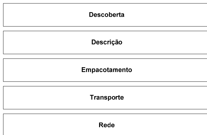
Figura A.2 – Pilha protocolar dos WS's. [75]
