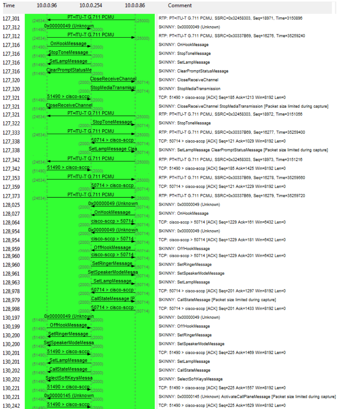
Figura 115 - Exemplo de finalização de uma chamada entre dois telefones da VLAN 1
