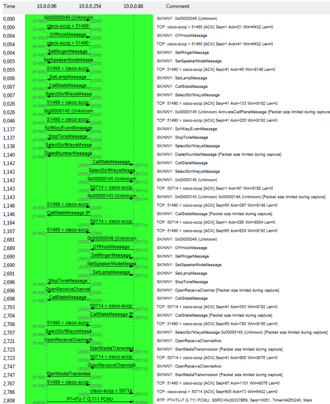
Figura 114 - Exemplo de estabelecimento de uma chamada entre dois telefones da VLAN 1
