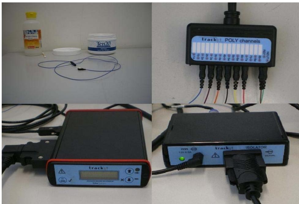
**Figura 3-2: Hardware de Aquisição (eléctrodo e material necessário à sua colocação, conector de eléctrodos, dispositivo principal e sistema de comunicação série)**
