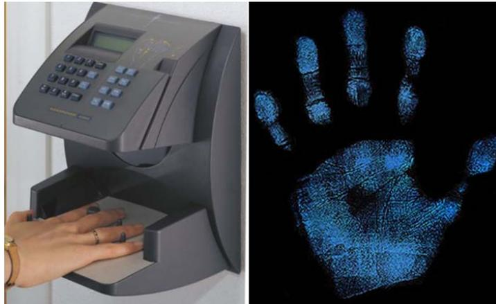
Figura 2-6: Sistema de autenticação baseado na geometria da mão e imagem de um *scan* resultante de um destes sistemas.
