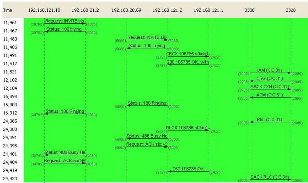
Figura 4.8: Chamada sem sucesso (terminal PSTN móvel ocupado).
