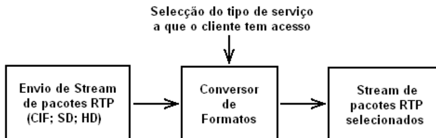
Figura 60 - Conceito base do conversor de formatos (Sistema de Conversão de Vídeo)
