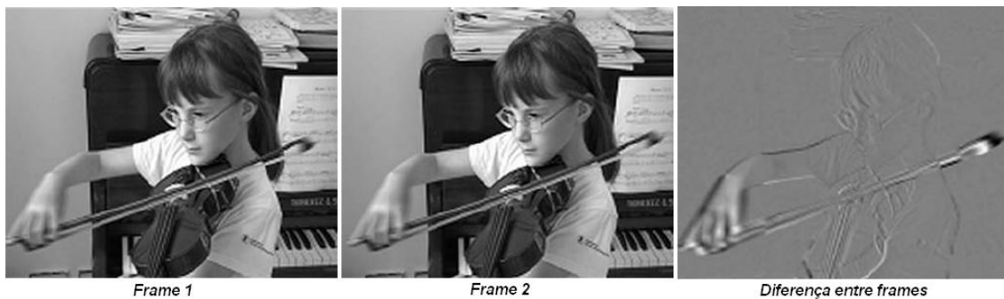
Figura 19 - modelo temporal - predição utilizando a frame anterior (adaptada de [5])
