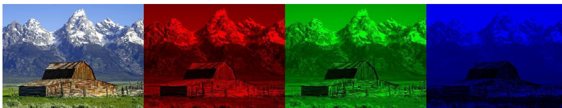
Figura 7 - Componentes de cor (vermelho, verde e azul) do espaço de cor RGB (adaptada de [7])
