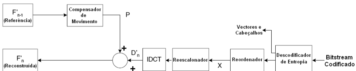
Figura 30 - Decodificador de vídeo DPCM/DCT (adaptada de [5])
