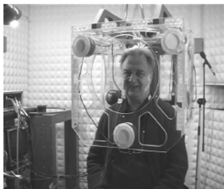
Figura 3.6 - Colocação esférica das seis bobines transmissoras utilizadas no sistema 3D AG 500 (a) e Helmet em forma de cubo no mesmo sistema, não sendo necessária a fixação da cabeça. Fonte: Zierdt et al. (2000).
