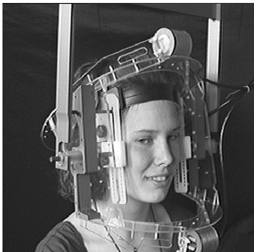
Figura 3.5 - Sistema AG 200 - Helmet onde se encontram as bobines transmissoras. Fonte: www.articulograph.com .
