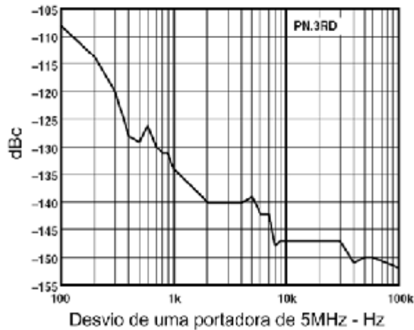
Figura 3.15 – Gráfico do ruído de fase da DDS AD9850.
