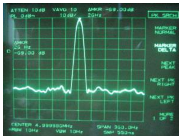
Figura 6.8 – Detalhe da risca, com Span=360Hz , para uma frequência fundamental de 5MHz.
