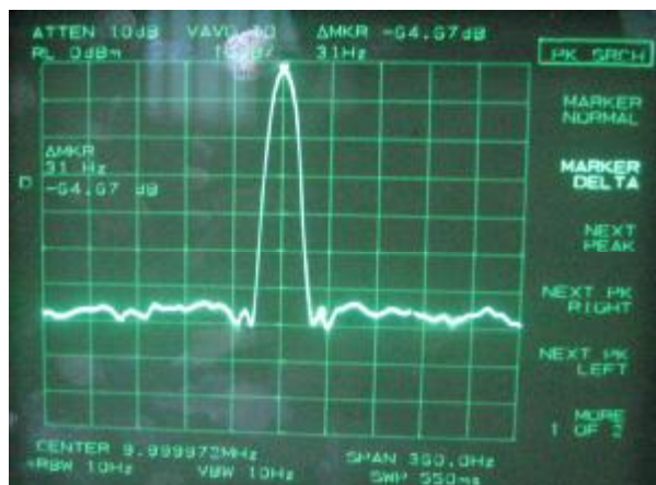
Figura 6.10 – Espectro, com Span =360Hz, para uma frequência fundamental de 10MHz.
