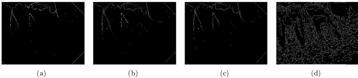
Figura 4.1: Comparação entre operadores de detecção de arestas. (a) Operador Roberts. (b) Operador Prewitt. (c) Operador Sobel. (d) Operador Canny.
