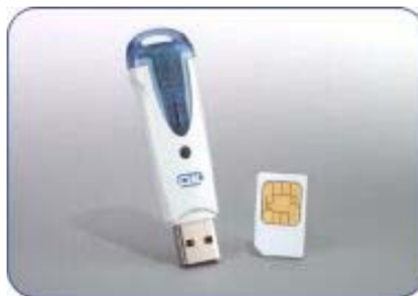
Figura 10: Exemplo de smart card e leitor USB dongle (OMNIKEY CardMan)
