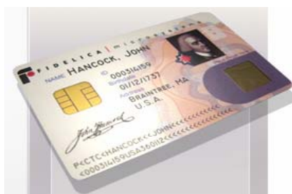
Figura 12: Cartão Smart Card com capacidades biométricas da Fidelica Microsystems
