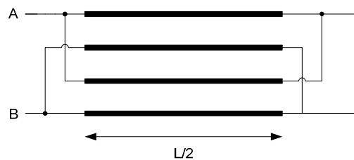
Figura 28: Linhas interdigitadas (vista de cima)
