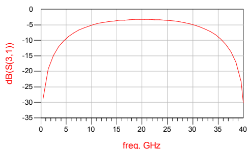
Figura 56: Acoplamento obtido entre duas linhas sobrepostas acopladas
