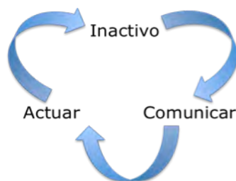
Figura A.5.1 - Máquina de estados do sistema de controlo
