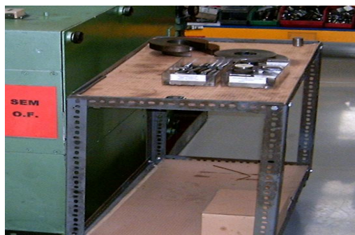
Figura 9 – Carrinho utilizado para transportar as ferramentas da estante até à máquina
