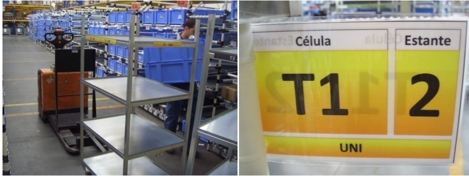
Figura 59 - Gestão Visual no Mizusumashi : Cor nos vagões correspondente à estante de supermercado e à célula que cada vagão abastece
