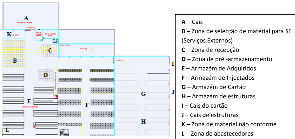
Figura 2 - Planta detalhada da área da logística
