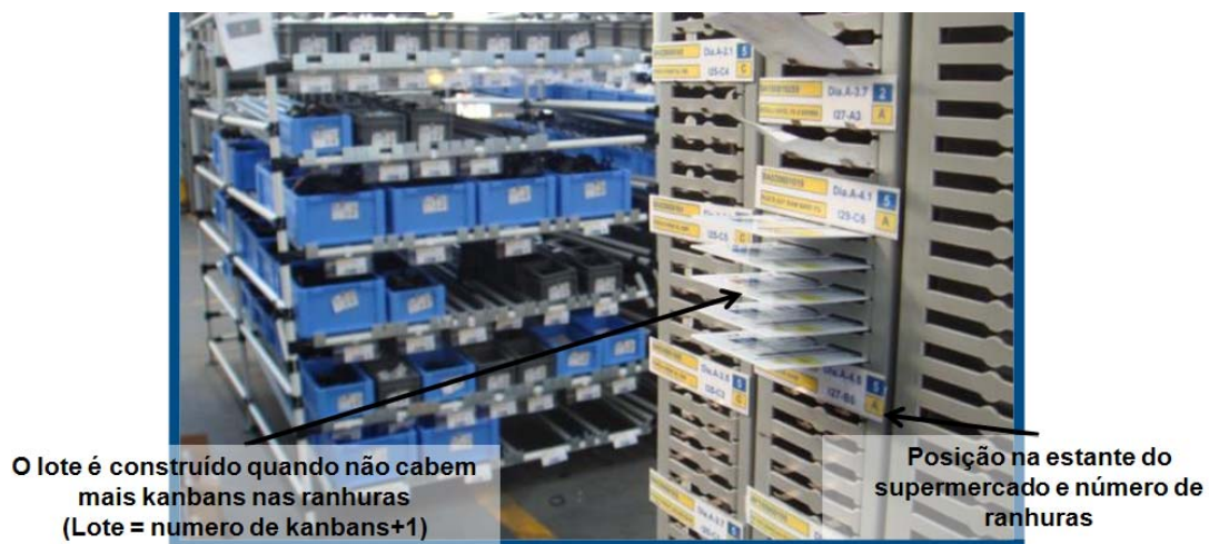
Figura 39 - Funcionamento da Caixa de construção de lote
