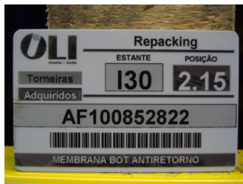
Figura 45 - Kanban de Reposição de Repacking
