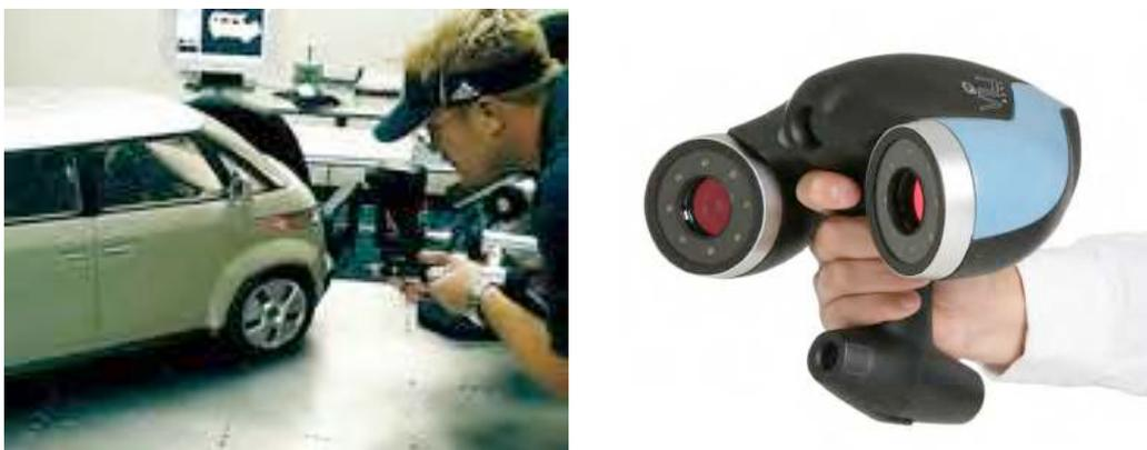
Figura 43 – Esquerda: Digitalização de um modelo tridimensional para recolha de dados da superfície, NVision Inc, 2004, <http://www.qualitymag.com/Articles>; Direita: Viuscan Laser Scanner, [http://www.metronom.com.au/3dlaser\\_scanner/viuscan.html](http://www.metronom.com.au/3dlaser_scanner/viuscan.html).
