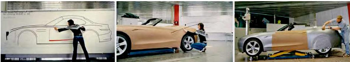
Figura 56 – Esquerda: BMW, representação bidimensional do BMW Z4 e89 realizada com fita de desenho (*tape drawing*); centro: modelo em barro à escala real; direita: aplicação de *Dynoc film* para acabamento de superfície do modelo, [http://www.bmwheaven.com/component/option,com\\_wrapper/Itemid,17](http://www.bmwheaven.com/component/option,com_wrapper/Itemid,17).
