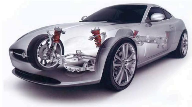
Figura 54 – Esta Ilustração do *Jaguar XK*, realizada a partir do *rendering* 3D do *Light Wave 3D*, mostra a suspensão do automóvel. Jaguar Cars, Coventry, England. Pipes, 2007, p.184.
