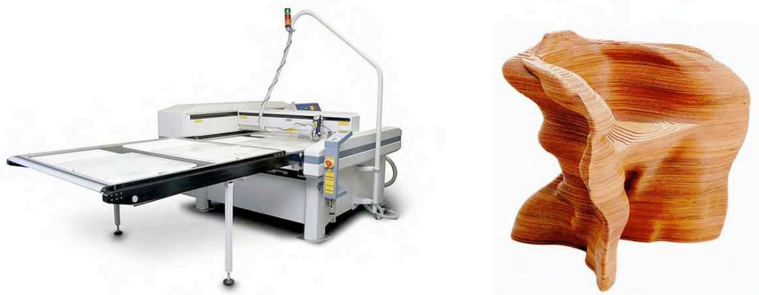
Figura 45 - Esquerda: Máquina de corte de acrílico a laser 2D, <http://www.directindustry.com/>; Direita: Mathias Bengtsson, “Slice chair”, 1999, cadeira construída a partir da junção de várias camadas de material, desenhadas em CAD e cortadas numa máquina de corte 2D, Pipes, 2007, p.24.
