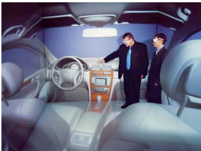
Figura 36 - Designers da Mercedes experimentam um 3-D virtual do interior de um automóvel através de “Design Cave” (Computer Aided Virtual Environment), Mercedes-Benz Design Center.
