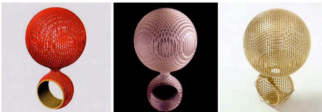
Figura 35 – Esquerda: David Goodwin, modelo 3D realizado com o software *Rhinceros*; Centro: modelo de resina epoxídica realizado por stereolitografia; Direita: anel acabado em ouro. Pipes, 2007, p.107.
