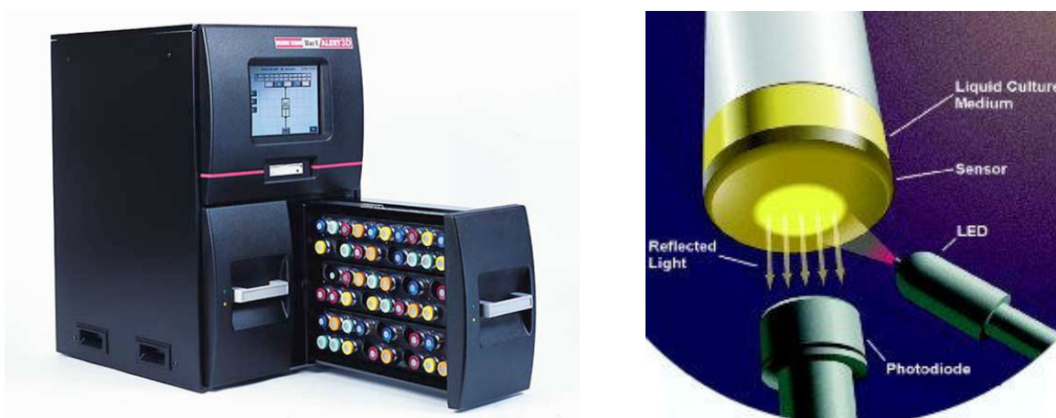
Figura 3. Sistema automático de monitorização contínua BacT/ALERT 3D, bioMérieux, COM a base da garrafa de hemocultura em pormenor, sendo visível o sensor.
