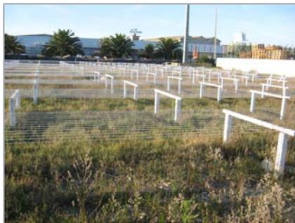
**Figura 45 - Estrutura de suporte para a seca do bacalhau**
