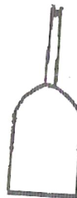
Figura 13 – Pá cova. Pá de forma côncava utilizada na remoção das lamas.
