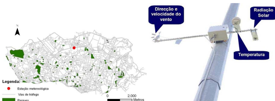
Figura IV.2 - Estação meteorológica automática, instalada na VCI.
