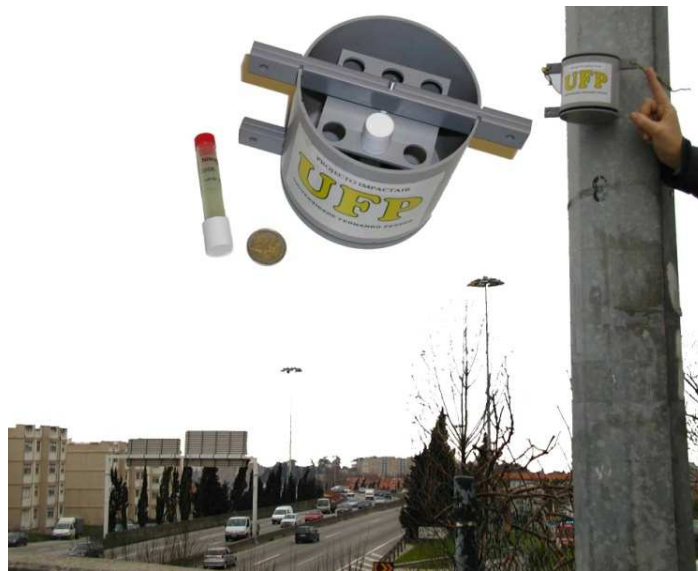
Figura III.6 - Amostrador passivo e respectivo abrigo colocado num poste de iluminação da VCI: sub-domínio do Amial.
