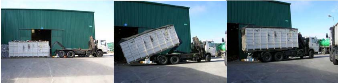
Figura 3-4 Sequência da operação de carregamento do contentor, contendo refugo, para deposição em Aterro.
