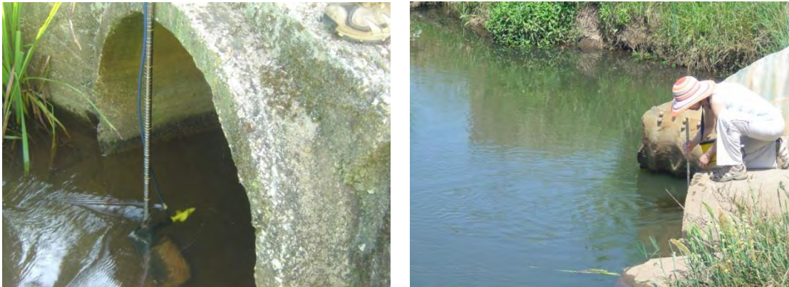
Figura 25 - Medição da velocidade com molinete à entrada do vale Central, Gomase (esquerda), e num local mais a jusante deste, Ponte das Lavadeiras (direita).
