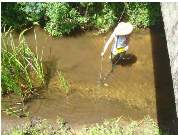
Figura 32 - Medição da velocidade com o molinete na entrada do vale do Foja, Ponte de Santana.
