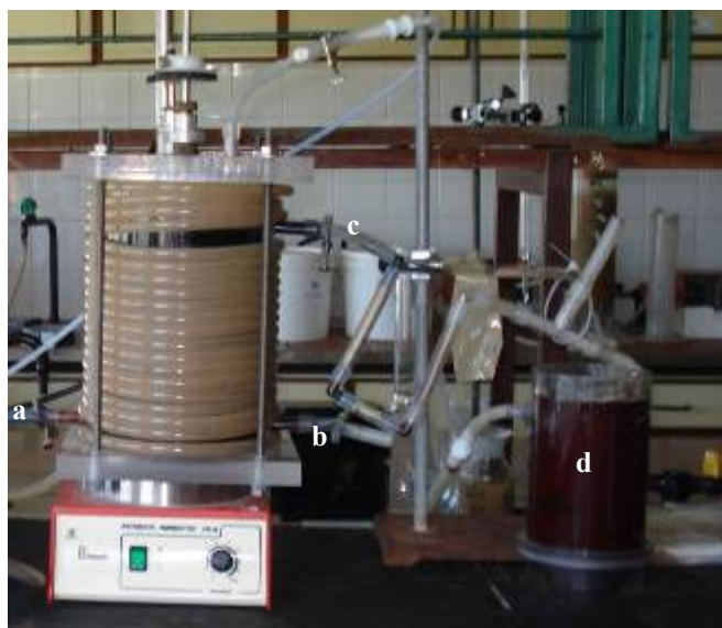
Figura 3.1 – Aspecto geral da montagem de um reactor acidogénico.
