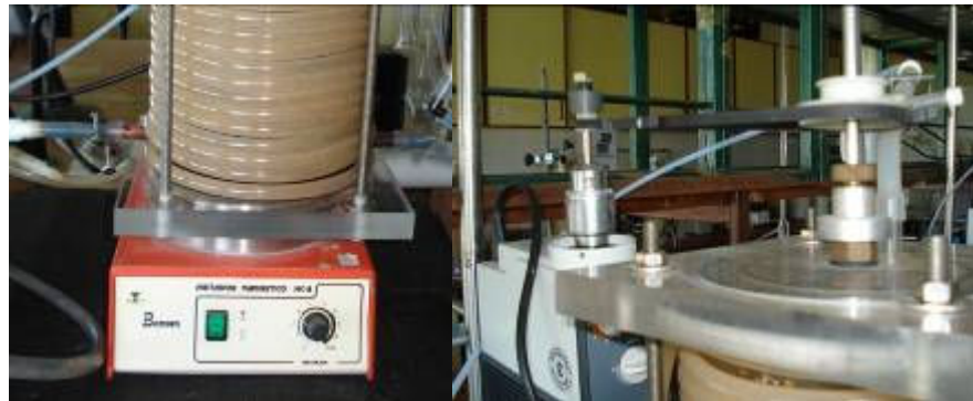
Figura 3.3 - Sistema de agitação dos reactores (na base constituído por um agitador magnético e no topo por motor-correia-veio).
