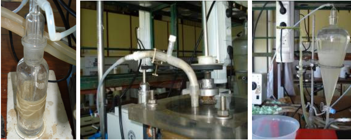
Figura 3.5 - Sistema de amostragem de biogás (borbulhador, derivação em T e ampola).
