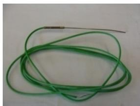
Figura 3.3 – Termopar utilizado no trabalho
