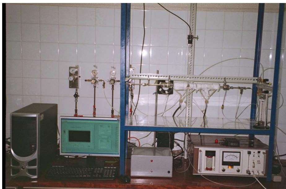
Figura 10 – Estrutura final do analisador termo-óptico C do DAO
