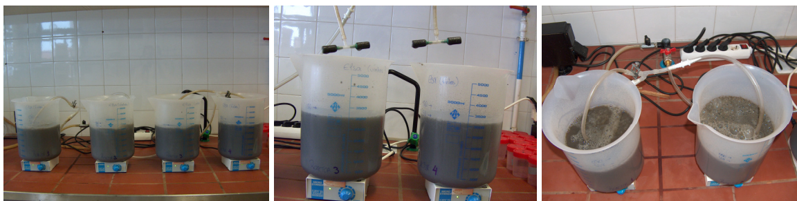
Figura 5 – Instalações laboratoriais dos ensaios de biodegradabilidade e sistema de arejamento
