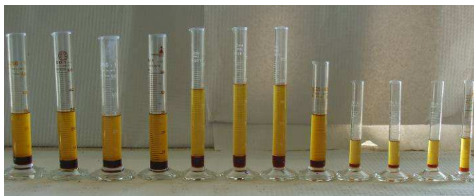
Figura 3.7 Mostra do método desenvolvido para acompanhar a extensão da reacção na catálise homogénea.
