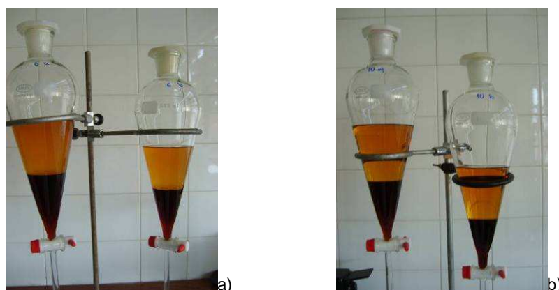
Figura 4.7 Fotografias da etapa de separação de fases (biodiesel/glicerina) nos ensaios conduzidos a diferentes temperaturas. a) Ensaio 6 (1,5% KOH, T = 60^{\circ}\text{C} ); b) Ensaio 10 (1,0% KOH, T = 70^{\circ}\text{C} ).
