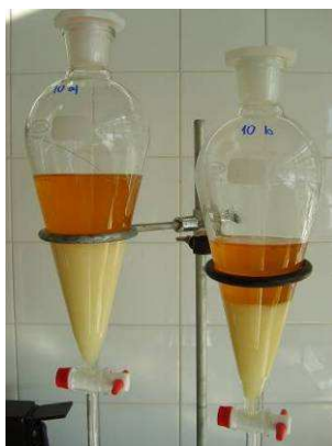
Figura 4.8 Fotografia da separação de fases (biodiesel/água de lavagem) após a 1ª lavagem (ensaio 10a e 10b).
