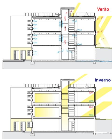
Figura 2.5 – Integração do sistema solar térmico passivo no Edifício SOLAR XXI, do INETI (URL:18)
