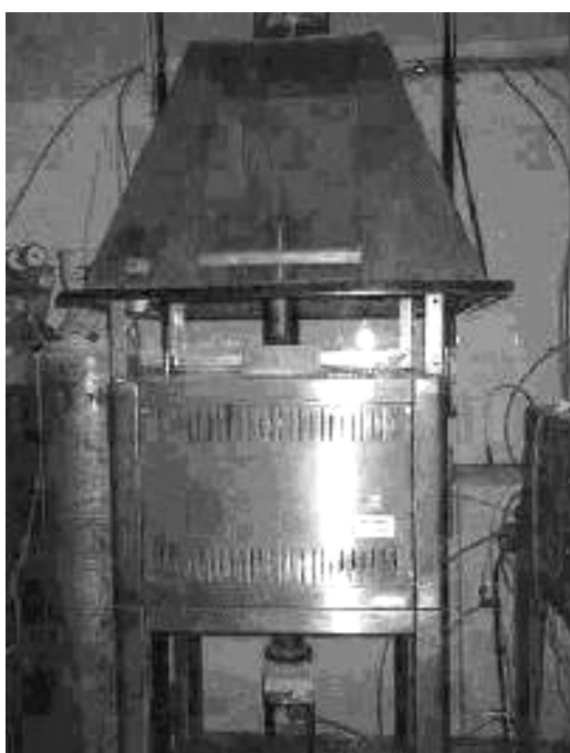
Figura 2.4 Reactor de activação dentro do forno (Pereira e Farinha, 2003)
