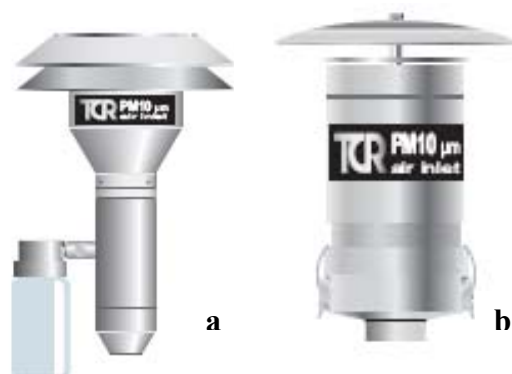
Figura - 7. Formatos das cabeças de amostragem utilizadas nas amostragens. Fonte: TECORA (2005).
