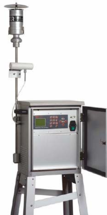
Figura - 6. Amostrador Tecora ECHO PM.
