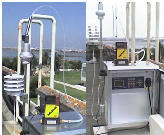
Figura.- 1 – Montagem para calibração do amostrador TECORA.
