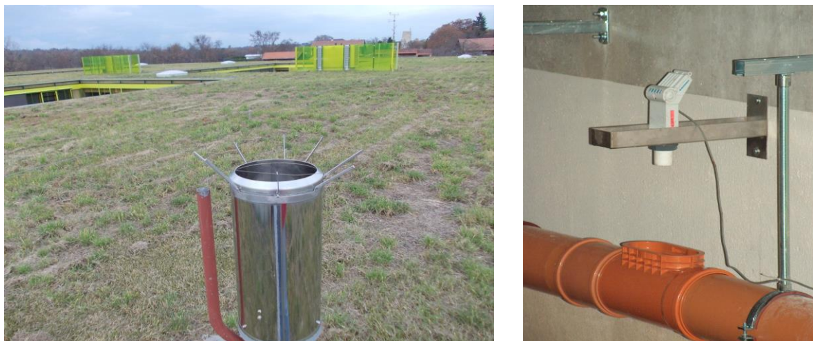
Figure 2 Equipement: pluviographe à augets basculants et Venturi avec mesure par radar.
