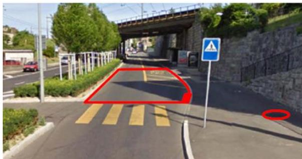
Figure 1 : Bassin versant de l'installation de traitement des eaux de ruissellement de chaussée d'une surface de 120 m<sup>2</sup>. L'ellipse rouge désigne la chambre de collecte. Le rectangle rouge en plein désigne la grille de collecte. Le rectangle rouge désigne le périmètre du bassin versant.
