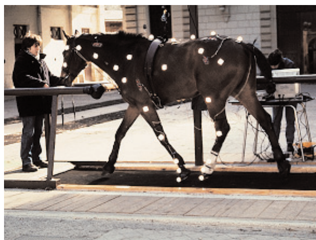
Figure 1 : Cheval équipé de capteurs EMG et de marqueurs cinématiques au trot sur tapis roulant.
