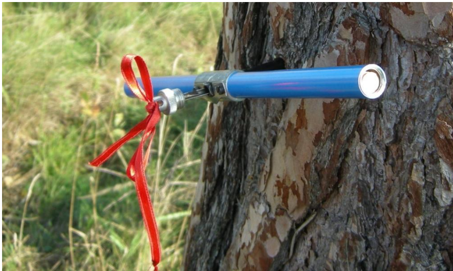
8. ábra A növedékfűró és a minta kivevő kanál fél fordulat visszafelé tekerés után. AJK22TR erdeifenyő minta (TEREPI FELVÉTEL)
