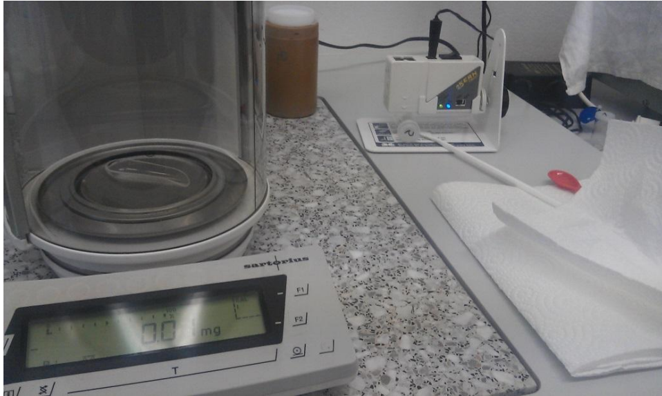
16. ábra Analitikai mérleg és elektrosztatikus töltést csökkentő berendezés
