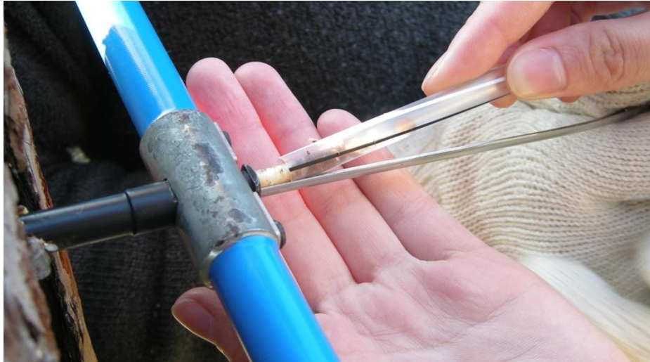
9. ábra A fűrőmag kivétel után azonnal műanyag szívószálba tétetett (TEREPI FELVÉTEL)
