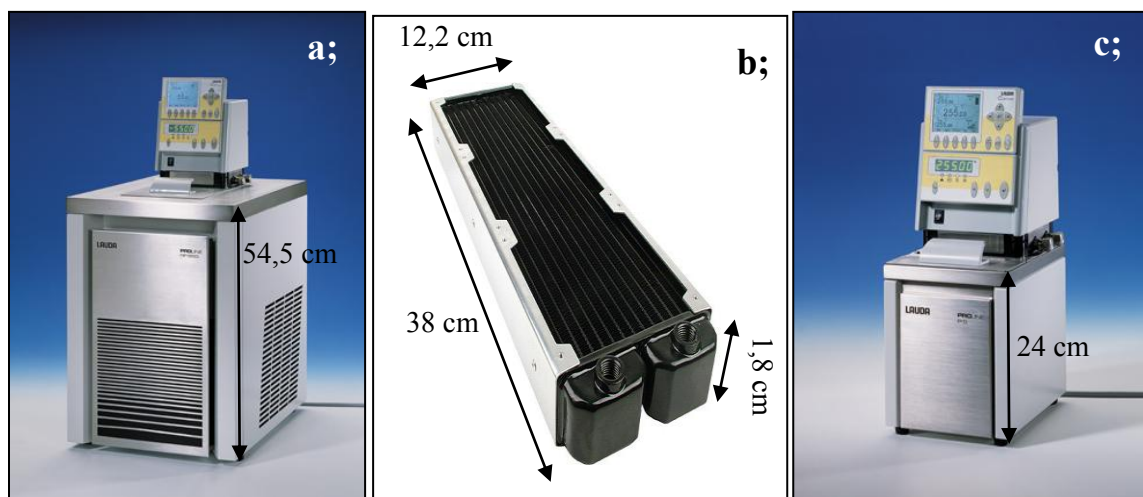
5.1.2. ábra: (a;) Lauda ProLine RP 855 hűtőtermosztát, (b;) hűtő-fűtő radiátor, (c;) Lauda ProLine P5 fűtőtermosztát.
