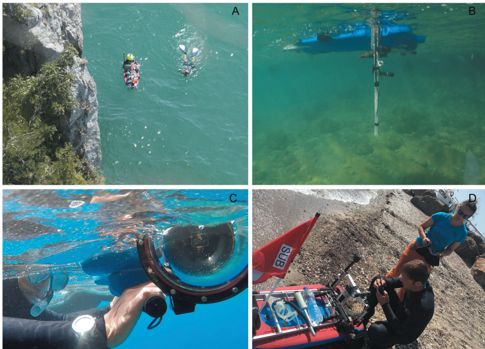
Fig. 2 - La strumentazione utilizzata durante i rilievi tra Sistiana e Duino. Il barchino utilizzato nei rilievi a nuoto. (A) Veduta dall'alto del barchino in navigazione; (B) l'asta posizionata a lato del barchino con le sonde CTD ed i termometri; (C) il dome laterale utilizzato per i rilievi fotografici; (D) approntamento del barchino.
