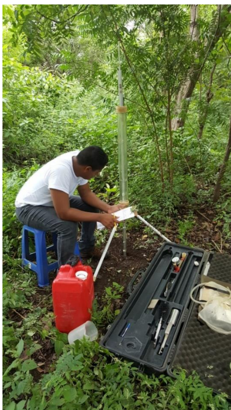
Foto 5. Levantamiento de datos de Prueba de Infiltración.
