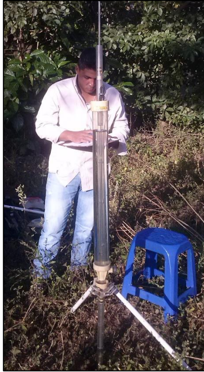
Foto 1. Realizando prueba de infiltración de suelo con el permeámetro de Guelph.
