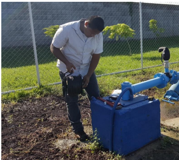
Foto 3. Realización de prueba de bombeo
