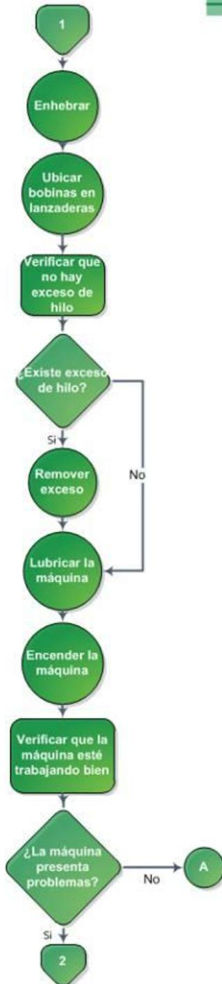
Ilustración 2: Diagrama de Flujo, Proceso de Telar
