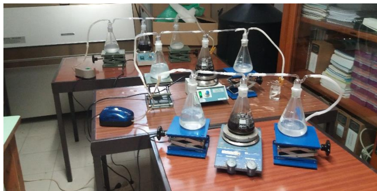
Figura 3.1 - Instalação do teste de Sturm para o estudo do artigo convencional (ensaio positivo), do branco e do produto Bio.
