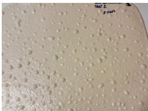
Figura 4.2 - Expansão térmica da espuma com masterbatch de 002 do fornecedor 1, a 160°C com tempo de residência de 2 minutos.
