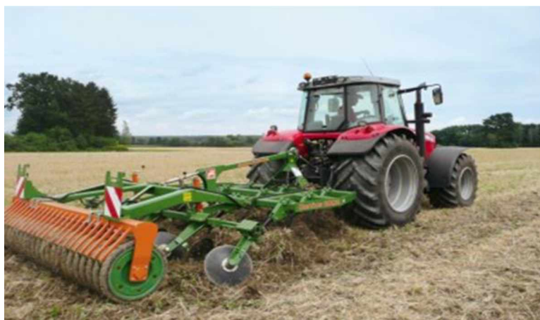
Figura 23 - Cultivador de braços flexíveis. (Deltacinco Agrícola, 2015).
