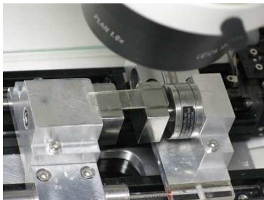
FIG. 2– Montage expérimental pour l'étude de l'endommagement interfacial par essai de traction.
