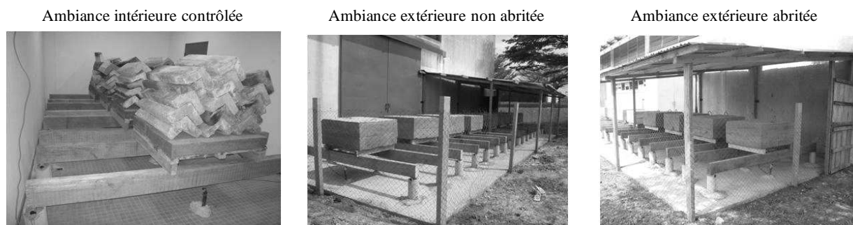
FIG. 1 – Dispositif expérimental à l'échelle structure pour les essais en flexion
