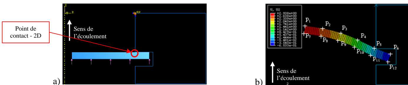
FIG. 7 – a) Membrane libre à l'état initial ( \Delta P=0 bar) et b) Déformation de la membrane pour \Delta P=0,2 bar (U déformation en mm).
