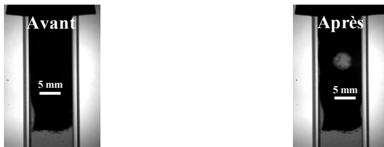
FIG. 4 – Photos d'un caillot sanguin avant et après une séquence de tirs pour une intensité  $I=1100 \text{ W.cm}^{-2}$  pendant une durée de 110 s.
