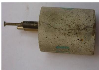
Photo.1- Echantillon fissuré
