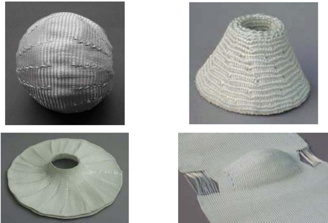
FIG. 5 – tricots multi-axiaux en forme 3D [7].
