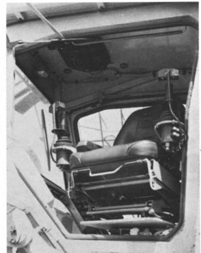
Photo 19. Le gros machinisme exige confort et facilité de conduite : la cabine du Scorpion avec climatisation et leviers de commande de l'hydrostatique.
