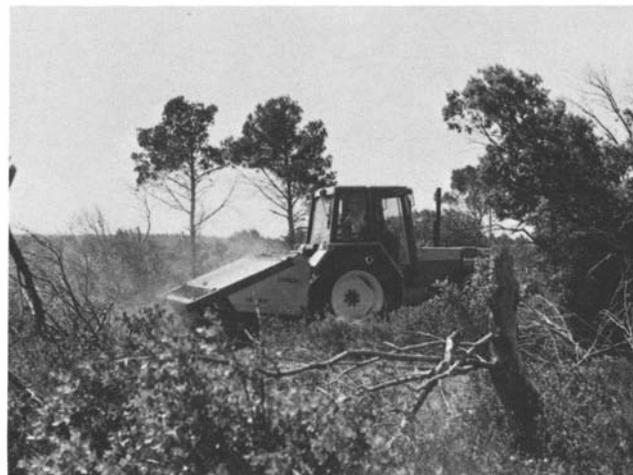
Photo 13. Le récupérateur du C.E.M.A.G.R.E.F. en conduite inversée. Photo F.B.
