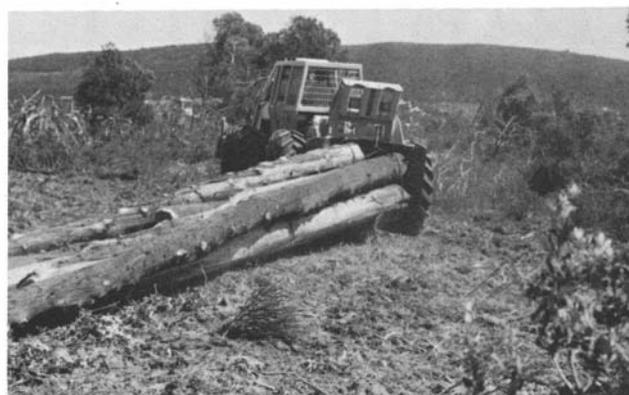
Il existe trois modèles de ce tracteur articulé avec lame de bull construit par **CEMET-AGRIP**. Le modèle 3000 est un engin classique d'un prix intéressant. Le 3500 S constitue une nouvelle génération de tracteur, idéal pour la forêt méditerranéenne; il est utilisé par l'Ecole forestière de la Bastide-des-Jourdans. Les modèles EC et TR 4000, très puissants, peuvent être employés sur gros bois dans certaines régions des Alpes.
