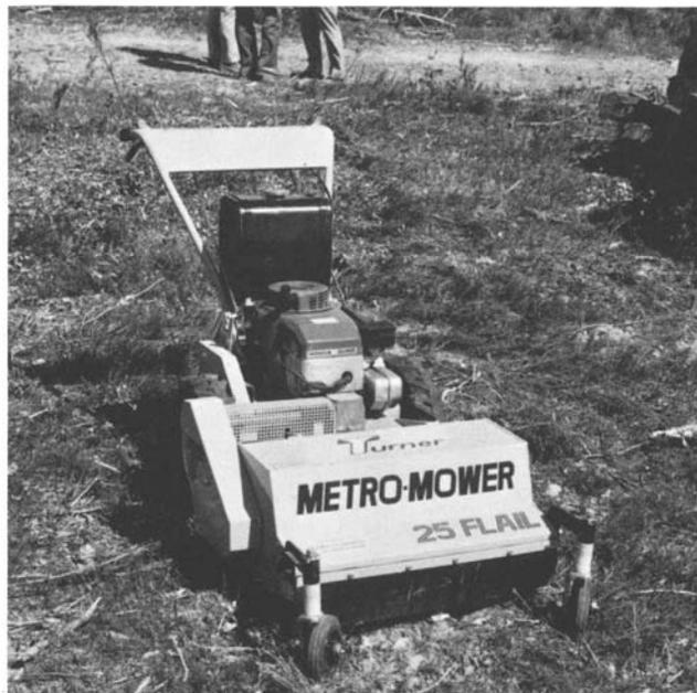
La même société tente de trouver un successeur au célèbre Gravely avec une petite débroussailleuse à axe horizontal de 0,76 m de largeur travaillante animée par un moteur Kolher de 14 CV à démarreur électrique. Cette débroussailleuse TURNER auto-tractée, également d'importation, devrait être commercialisée à un prix qui serait de l'ordre des deux tiers de celui du Gravely.
