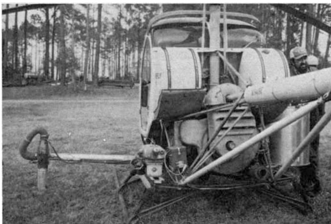
Photo 8. - Allumage par hélicoptère : gas-oil enflammé.
