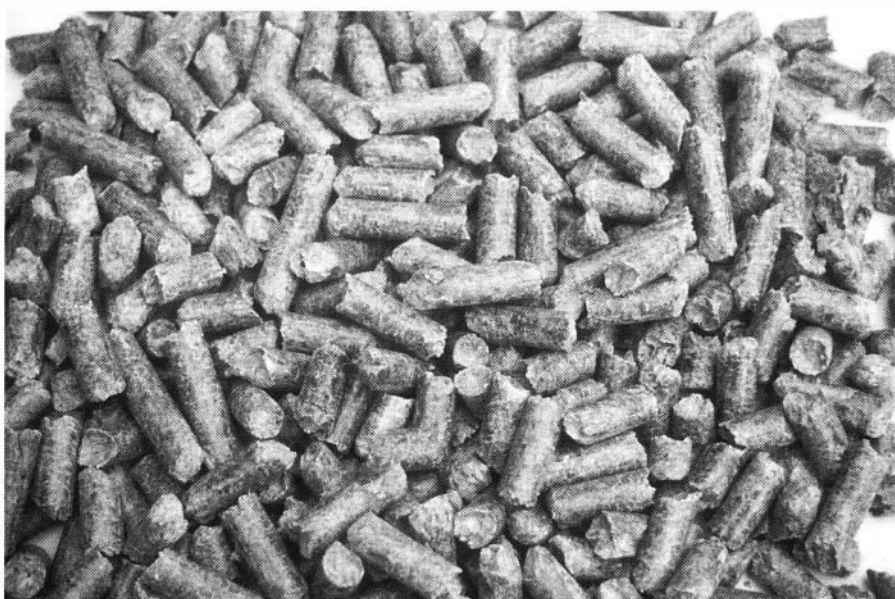
Photo 1 : Ces granulés issus de la sciure et des déchets de broyage peuvent être utilisés pour le chauffage collectif.
