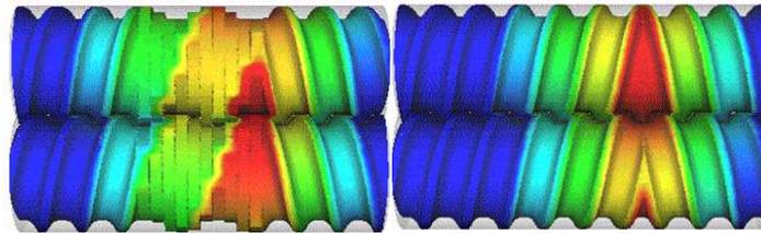
FIG. 10 – Champs de pression à vitesse de rotation et débit constants pour un bloc d'éléments malaxeurs d'épaisseur 5mm et décalés d'un angle de 30° (à gauche) et pour un élément de vis de pas=33,3 mm. Pression variant de 0 (bleu) à 10 MPa (rouge).
