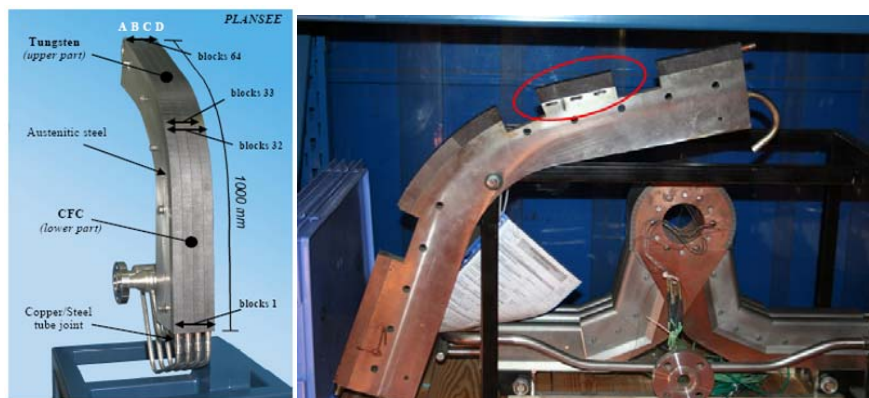
FIG. 2 – Maquette testée sous flux thermique cyclique et monoblocs prélevés.
