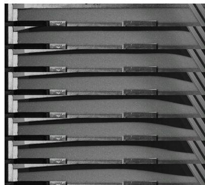
FIG. 2 – Acquisition d’images à la caméra rapide, le temps entre 2 images est de 200 ms. On peut voir la propagation des fronts amont et aval.
